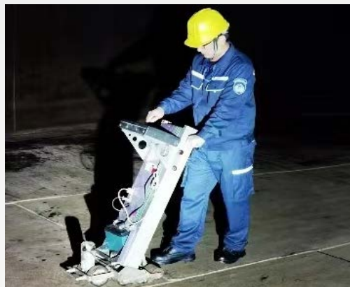
罐底板漏磁检测
